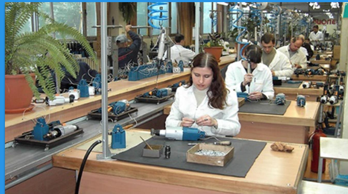
Сборка электроинструмента на конвейерах с заданным тактом
